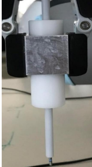
6. ábra Általunk tervezett és gyártott rúgós kontakterő-mérő eszköz, amely képes az érintkezési erőt stabilan 0,3 N-ra beállítani, ezen halad keresztül az ablációs elektróda.
