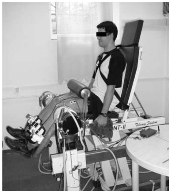
6. ábra. A vizsgált személy elhelyezkedése a Multi-Cont II Tihanyi System izomvizsgáló berendezésen bilaterális térdfeszítés során.
