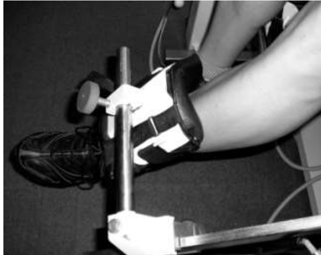
5. ábra. A lábszár rögzítésének módja a szervomotor által forgatott acélkarhoz.
