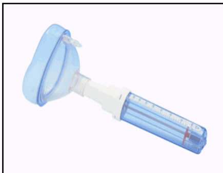
8/a. ábra Nasalis inspiratorikus csúcsáramlás (PNIF) mérőeszköz (In-Check Nasal™, Clement Clarke International LTD) [217]
