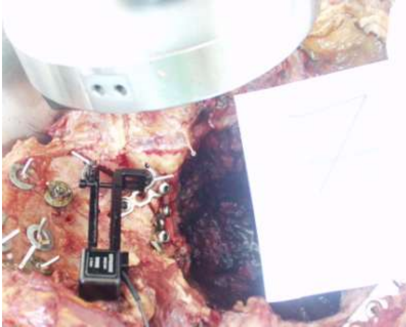
8. ábra: a massa lateralisra létrehozott Denis I. törés, valamint az azt rögzítő direkt lemezes synthesis
