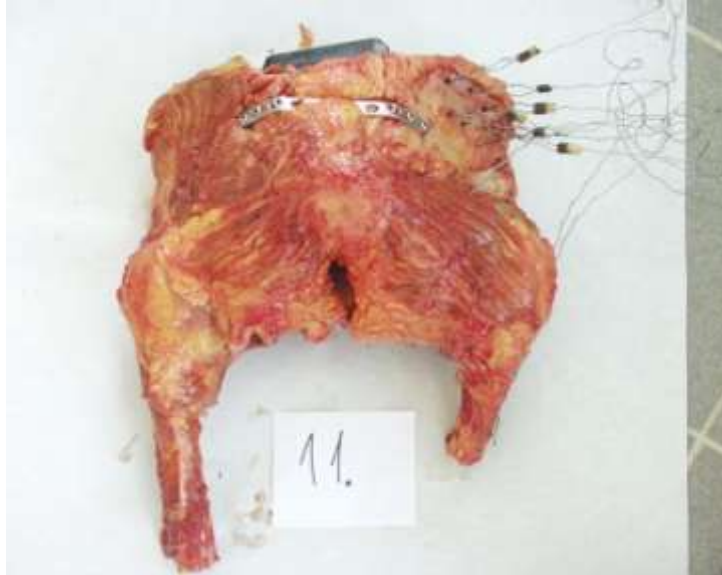
12. ábra: a jobb csípőlapáton láthatóak a glutealis izomzatot szimuláló drótok.
