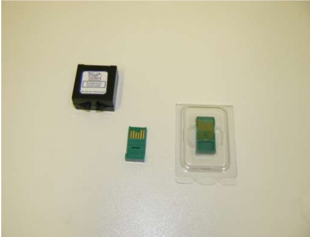
8. ábra: A Triage Meter BNP-re specifikus EPROM chipje
