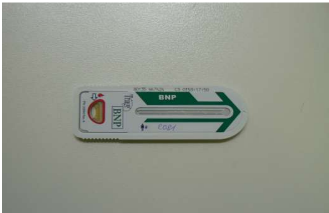
7. ábra: Egyszerhasználatos, eldobandó BNP-re specifikus műanyag reagensbetét Triage Meter készülékhez
