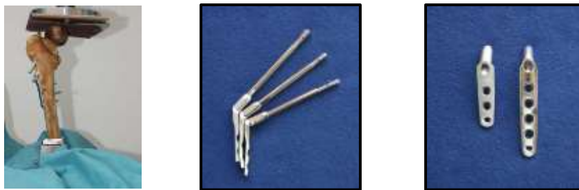
50. ábra: DCD toldalék mechanikai terhelhetőségének vizsgálata és a toldalékok
