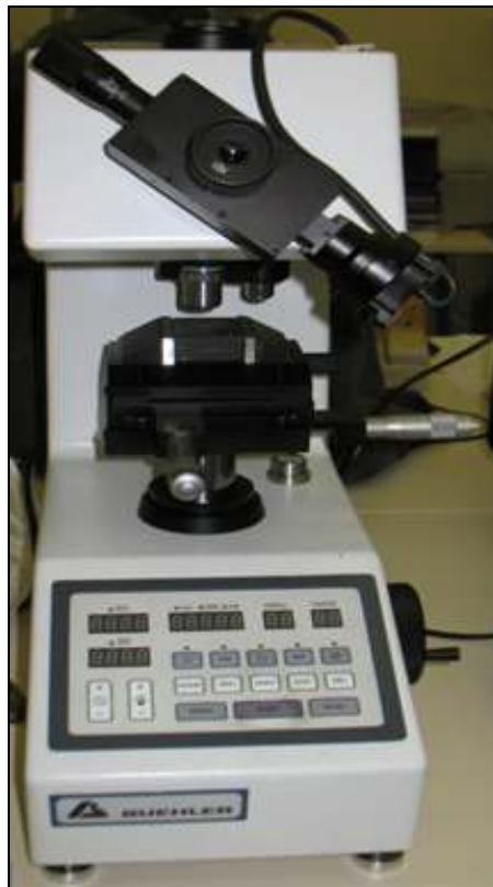
9.ábra: A mikrokeménység mérő műszer, melyet Smith és Sandland fejlesztette ki Londonban a Vickers Ltd.-nél, 1922-ben, majd Lips és Sack tovább fejlesztette az alacsony erők tartományában (Micro Vickers) 1936-ban.
