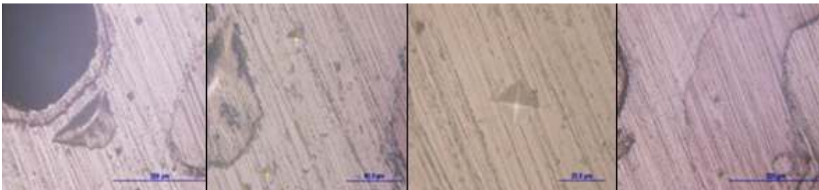
14. ábra: Lenyomatok aranyozás után, A.TCP, B.allocsont, C.Bioss, D. gyanta. (Terdik és mtsi.)
