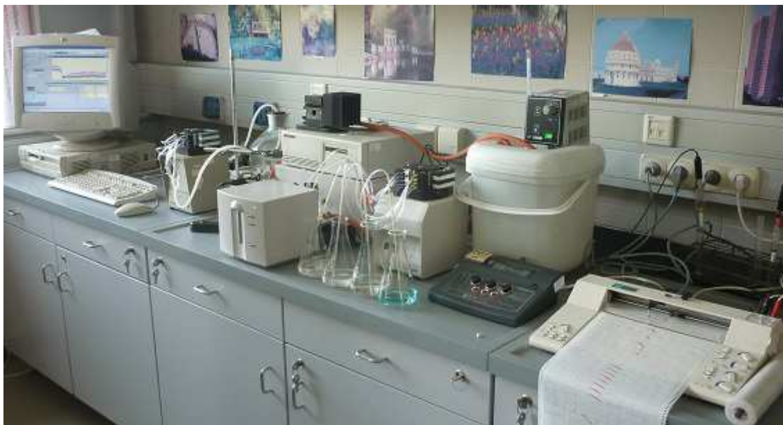
20. ábra: Nyitott rendszerű oszcillátorok spektrofotometriás követésére alkalmas kísérleti berendezés
