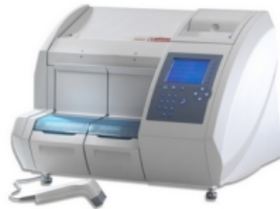
17. ábra. HIV p24 antigén ELISA kvantitatív kimutatásra használt készülék (MiniVIDAS ® , BioMérieux, France)
