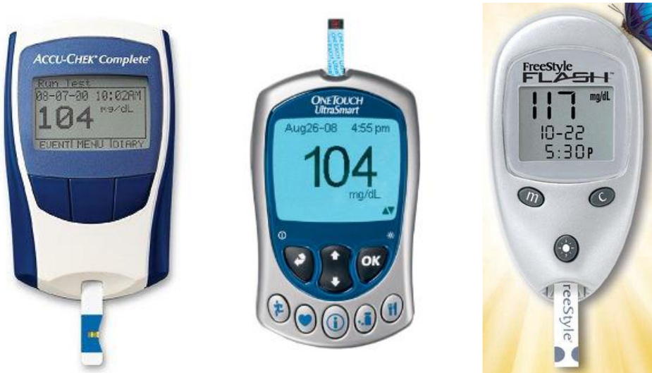
4. ábra. A praxisban elterjedt néhány bioszenzoros glukométer: Accu-Chek Complete Meter (Roche), OneTouch UltraSmart (Lifescan), FreeStyle Flash (Abbott).
