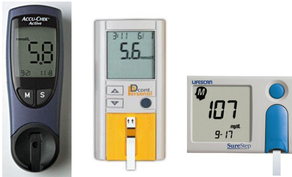
3. ábra. A hazai praxisban elterjedten használt reflexiósz glukométerek: Accu-Check Active (Roche), Dcont Personal (77 Elektronika), OneTouch Surestep (Lifescan).
