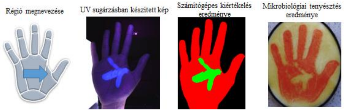
31. ábra: Biolab Zrt. Mikrobiológia Laboratóriumában végzett mikrobiológia vizsgálat eredménye. Az első képen a szabad kézzel rajzolt ábrát mutatjuk. A második kép az UV markert tartalmazó fertőtlenítőszerrel végzett bedörzsölés eredményét mutatja UV-A sugárzásban. A harmadik felvétel a Hand-In-Scan rendszer képfeldolgozó szoftvere által végzett kiértékelést mutatja. A negyedik felvételen a mikrobiológia tenyésztés eredményéről készült digitális felvétel látható.
