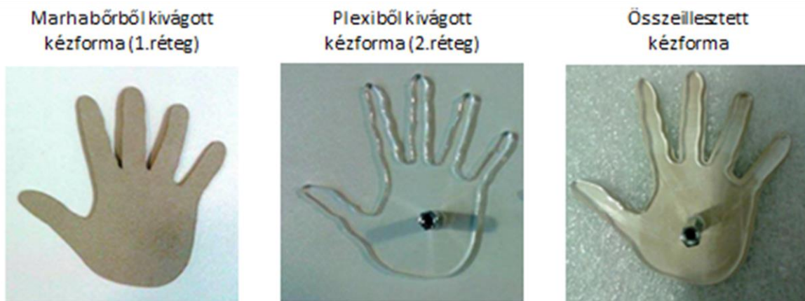
22. ábra: A 8 cm-es kézmodell készítésének lépései: marhabőrből készített kézfelszín, plexi váz és az összeszerelt modell.
