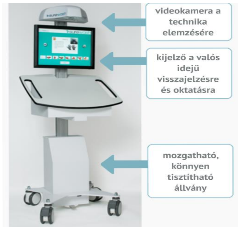
7. ábra: SureWash készülék felépítése: bedörzsölés technikájának oktatására és ellenőrzésére fejlesztett, ipari kamerával rögzített számítógépes mozgókép feldolgozás segítségével működő rendszer. ( www.surewash.com )
