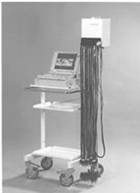
24. ábra. A Procardio rendszer 63 unipoláris elvezetéssel. Az ábrán láthatók az unipoláris elektródák, amelyek a „patient terminal box”-ba futnak.
