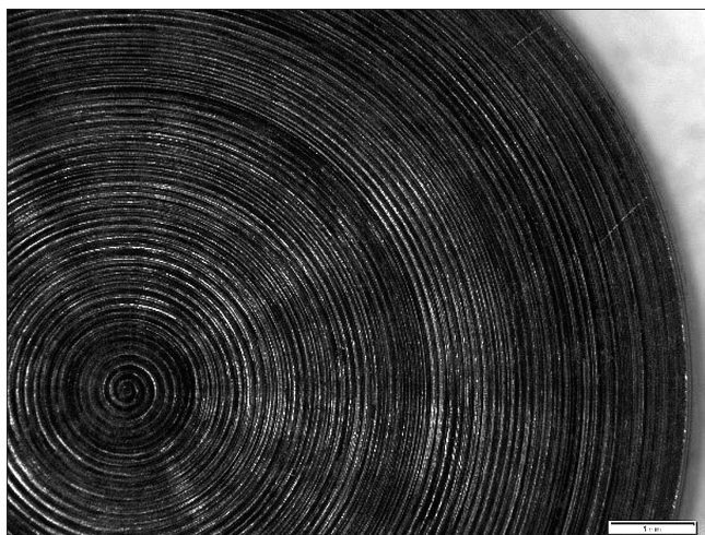
2. a, b ábra: Esztergált Grade5 titánkorongok felületei (sztereo- és scanning elektronmikroszkópos képek)
