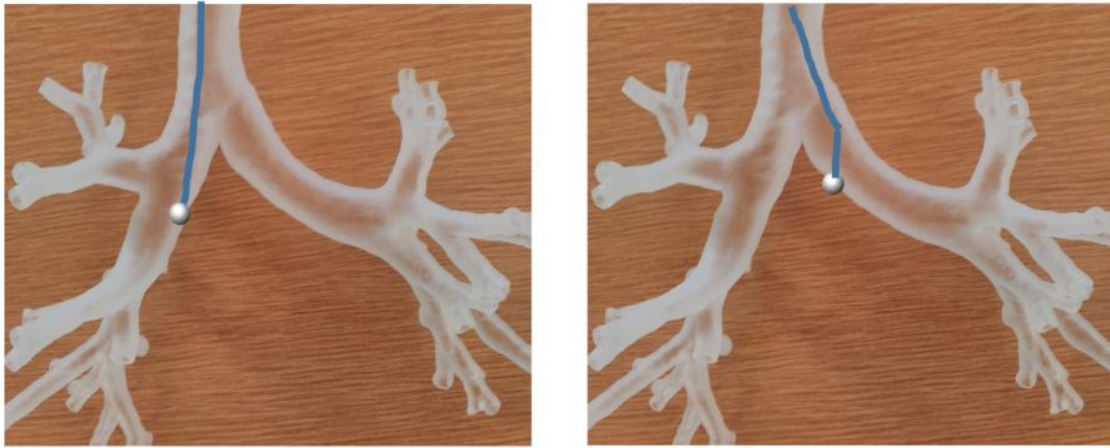
4. ábra: Inerciális impakció (baloldali) és gravitáció (jobboldali) általi kiülepedés.
