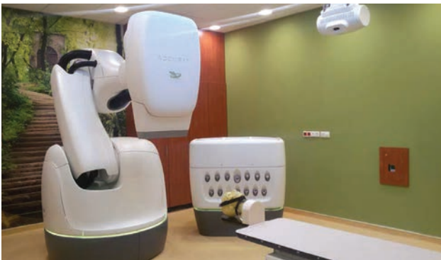
2. ÁBRA. Az Országos Onkológiai Intézetben telepített, legújabb generációs CyberKnife besugárzó, sokleveles (multileaf) kollimátorral
