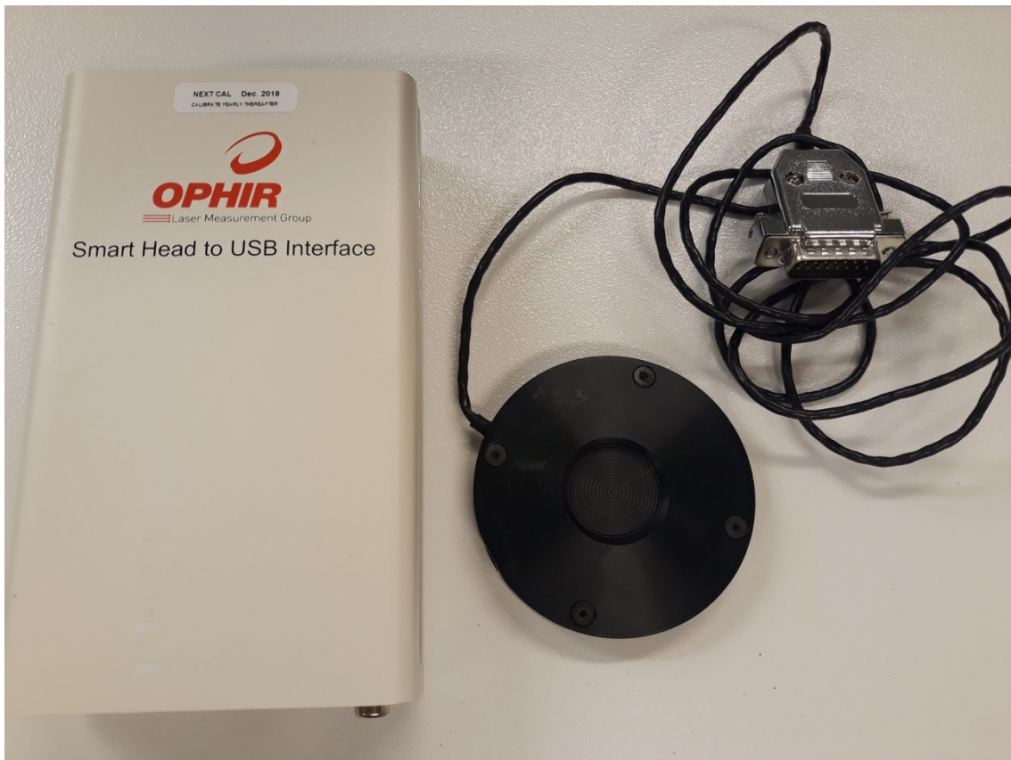
17. ábra: USB interface és UV-C tartományú mérőfej
