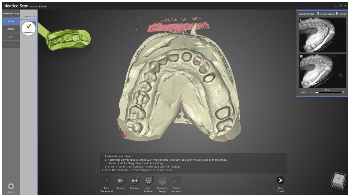
21. ábra Egy felső fogívről vett precíziós-szituációs lenyomat digitalizált adata. Az 12-13 fogak éli részénél látható rózsaszín felülettel jelzi a szoftver, hogy az adatfelvétel ezeken a területeken hiányos. (Temple Roland ftm. anyagából)
