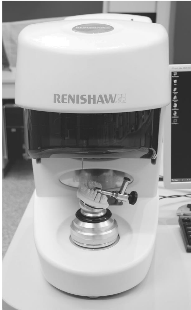
17. ábra Az egyik napjainkban is forgalomban lévő kontakt szkener a 3i Incise (Renishaw, UK), egy szekciós minta digitalizációja közben [54] (Kiadó engedélyével).
