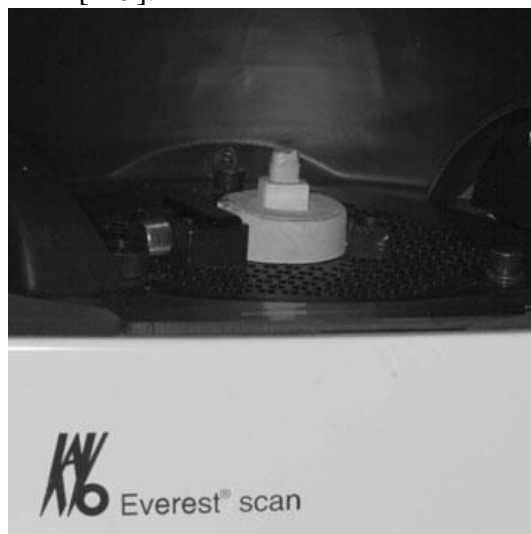
43. ábra Tan és mtsai vizsgálatukban egy moláris fogat mintázó gipszcsonkokat digitalizáltak optikai fogtechnikai szkennertel [129] (Kiadó engedélyével).
