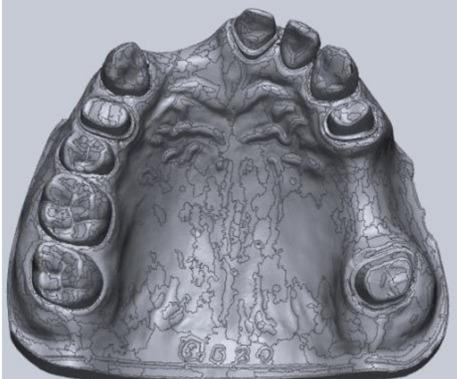
25. ábra A PMMA mintáról a referencia szkennelvel készített STL formátumú virtuális minta, amit a későbbiekben referencia adatként használtunk
