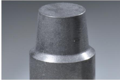
42. ábra Mandelli és mtsai által 7 fogtechnikai szkennert pontosságának méréséhez használt titán csonk [59] (Kiadó engedélyével).
