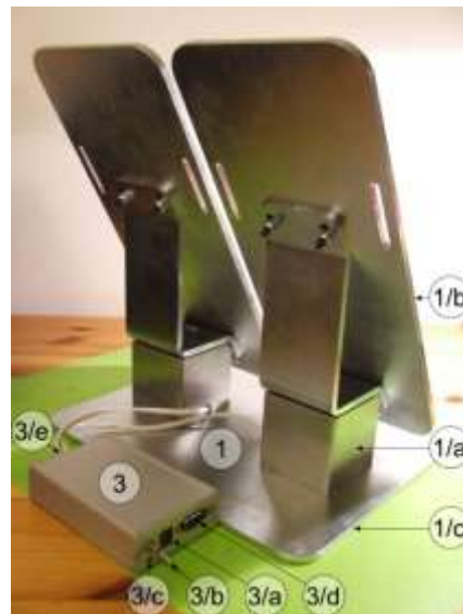
21. ábra A láberőmérő és az elosztó doboz.
