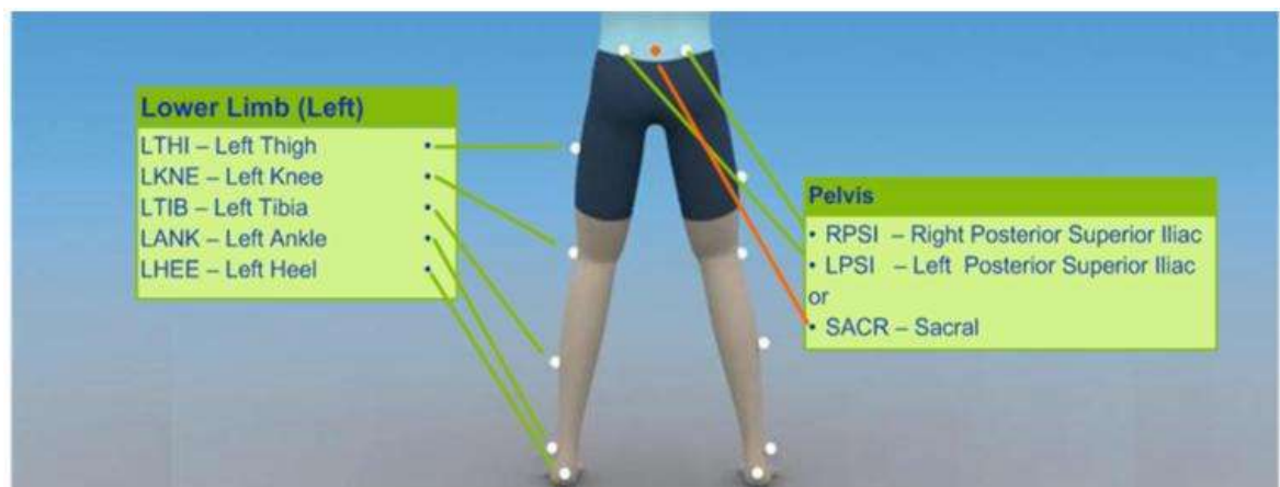
5. ábra Az alsó végtag és a medence markereinek felhelyezési rendje hátul nézetből. ( https://documentation.vicon.com/nexus/v2.2/Nexus1_8Guide.pdf )
