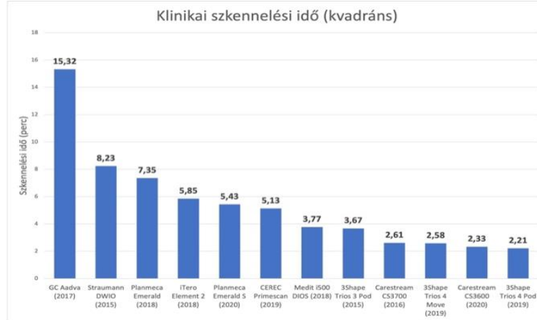
26. ábra Klinikai szkennelési időeredmények kvadráns digitális lenyomatvételek esetén
