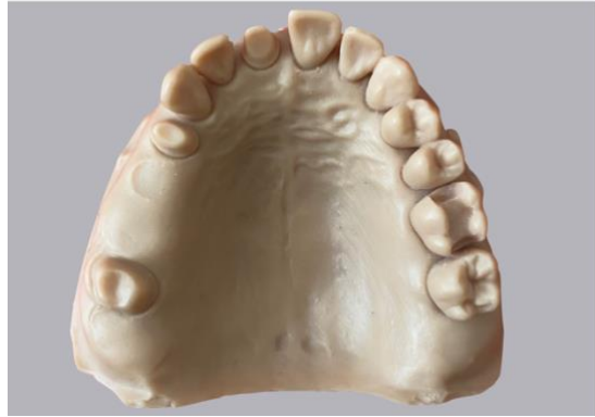
15. ábra A modell szkennelések során használt PMMA minta
