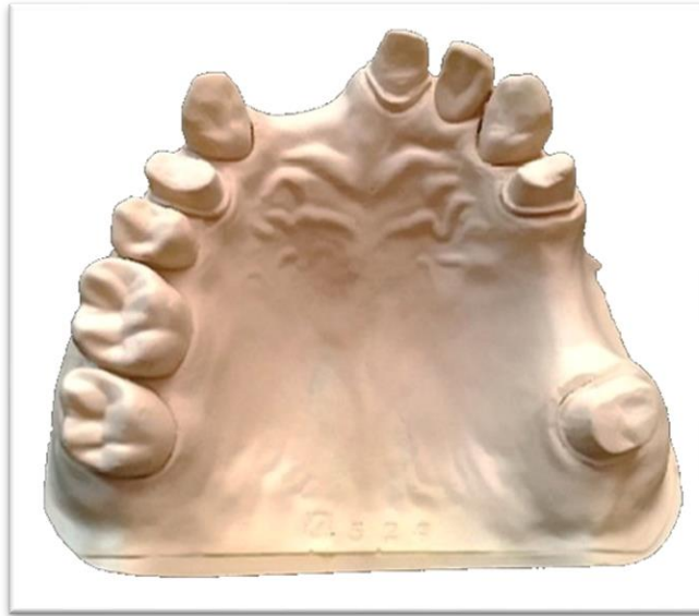
3. ábra: Az első két vizsgálat során használt PMMA minta fényképe (saját ábra)
