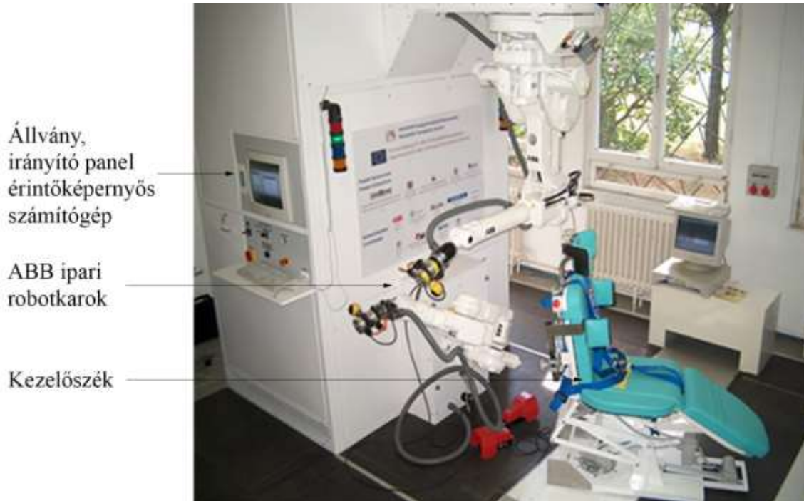
31. ábra: A Reharob Gyógytornásztató Berendezés korábbi felépítése
