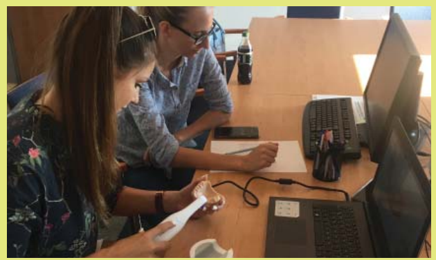
6. ábra: Fogorvostan-hallgatók in vitro vizsgálat során mintát szkennelnek Medit i500 DiOS 4.0 szkennelvel. A szkennelési idő és az elakadások száma feljegyzésre került
