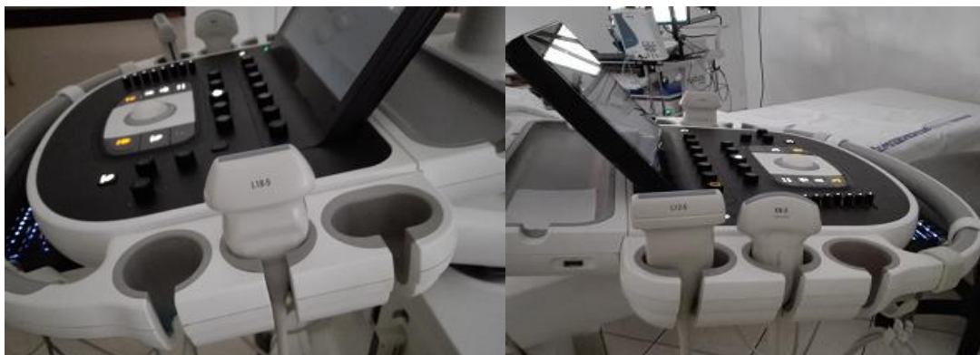
4. ábra. Vizsgálatainkhoz használt transzducerek. Bal oldalon 18-5 MHz-es vizsgálófej. Jobb oldalon 12-5 és 9-2 MHz-es vizsgálófej. Philips Epiq 5G ultrasound system.
