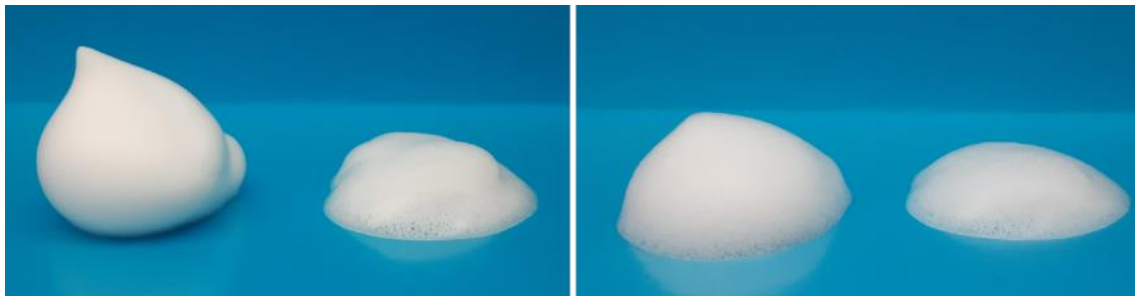
4. ábra Aeroszol és hajtógáz nélküli hab a kinyomás után közvetlenül (balra) és 3 perccel később (jobbra) – saját fotó
