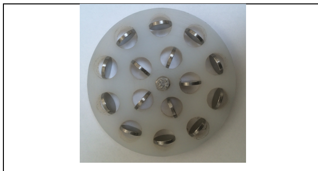
3. Ábra: A vizsgálati minták rögzítéséhez alkalmazott befogó. (saját képanyag)
