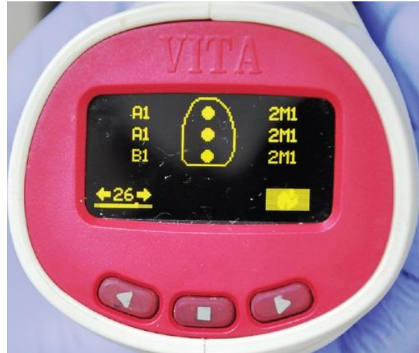
18. ábra A VITA Easyshade kézi spektrofotométer (saját ábra)
