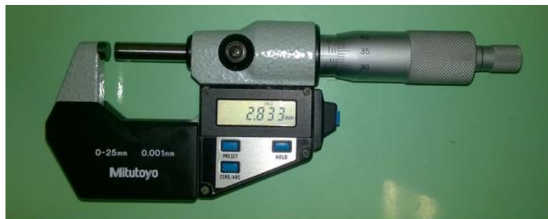
24. ábra Mitutoyo Digimatic IP65 digitális tolómérő (saját ábra)
