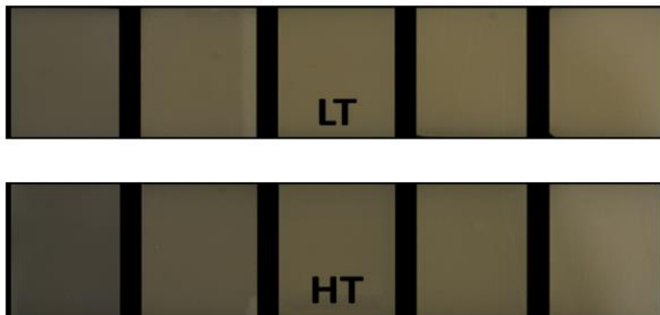
27. ábra Levágott és felületkezelt IPS e.max CAD A1-es színű, alacsony (LT, fent) és magas (HT, lent) transzlucenciájú, 12x14 mm-es kerámiaszeletek 0,5 mm; 1,0 mm; 1,5 mm; 2,0 mm; 2,5 mm-es rétegvastagságban (saját ábra)
