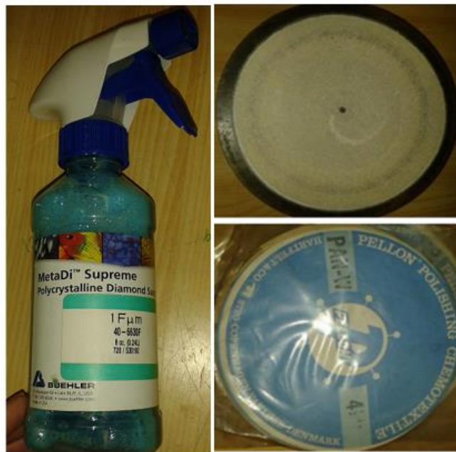
23. ábra A felület kezeléséhez felhasznált anyagok. A bal oldali képen a gyémántsuszpenzió, jobb oldalon a bronzba ágyazott szintergyémánt korong (fent) és a Pellon-korong (lent) látható (saját ábra)
