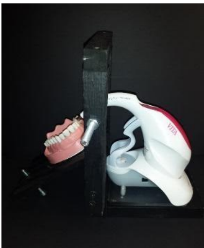
21. ábra: Vita Easysahde Advance 4.0 spektrofotométer és a bukkális mérőpontot stabilizáló állvány a mulázssal (saját ábra).
